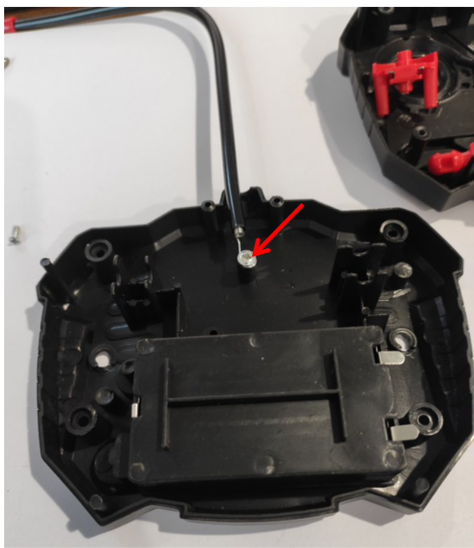
焊接电池盒引线，先给电池盒两个引脚镀锡
